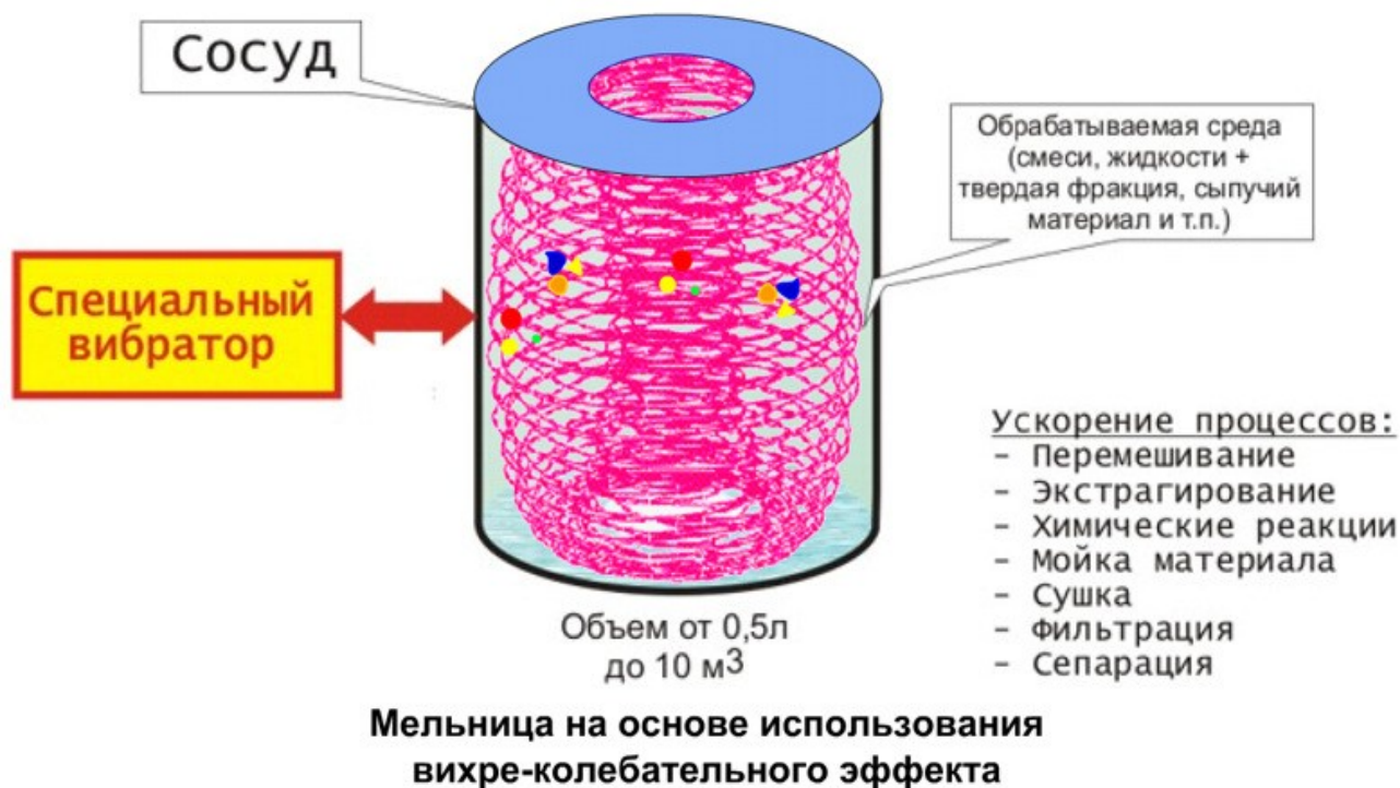
фиг.2. Мельница с интенсивным вихревым движением и одновременным колебанием частиц в вихре.
